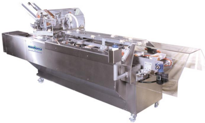
Se carga el depósito de alimentación de fundas de la máquina con fundas estándar de cinco pliegues preencoladas. La máquina selecciona una funda y la abre en un utillaje que le da forma. A continuación la funda abierta pasa por una área de carga de producto en la que se carga el envase de forma automática o manual. El producto enfundado sale en línea por las cintas de descarga.
